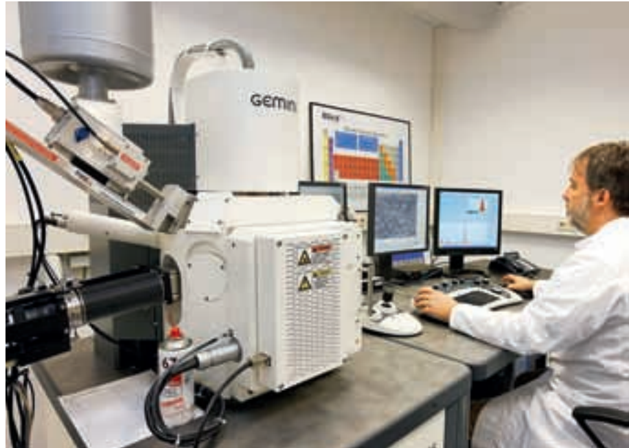
Le nouveau microscope électronique à champ d'émission par balayage permet de visualiser des microstructures de l'acier extrêmement fines et complexes (ici : un acier à très haute limite d'élasticité pour les pipelines).
