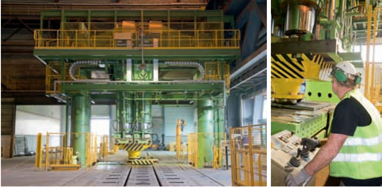
La nouvelle presse de dressage dans la tôlerie, la plus grande et plus puissante presse de ce type au monde
