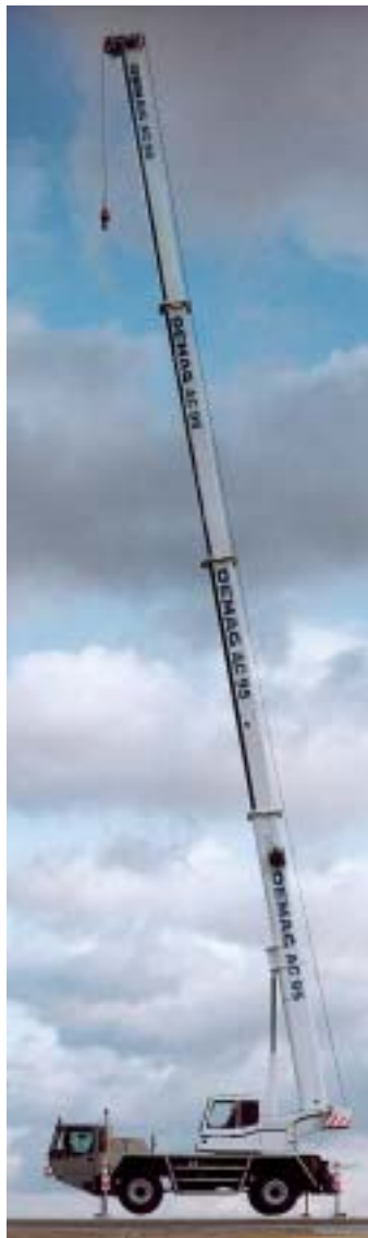
Figure 1 : Sans les aciers HLE tels que DILLIMAX, il serait impossible de construire des flèches de grues d'une telle longueur (photo publiée avec l'aimable autorisation de Demag Mobile Cranes GmbH, Zweibrücken, Allemagne)
