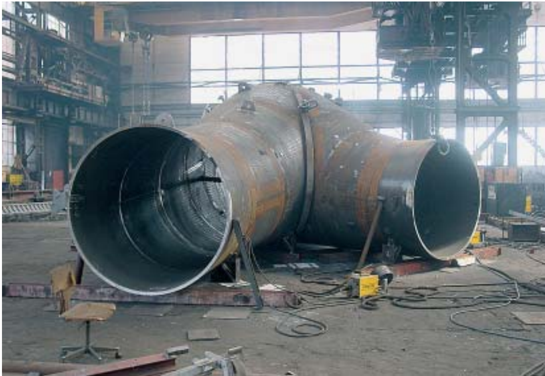
Figure 6 : Eléments de conduites en DILLIMAX 690 utilisés dans les conduites forcées de la centrale hydroélectrique Kárahjúcar (photo publiée avec l'aimable autorisation de l'entreprise DSD Noell GmbH, Würzburg, Allemagne)
