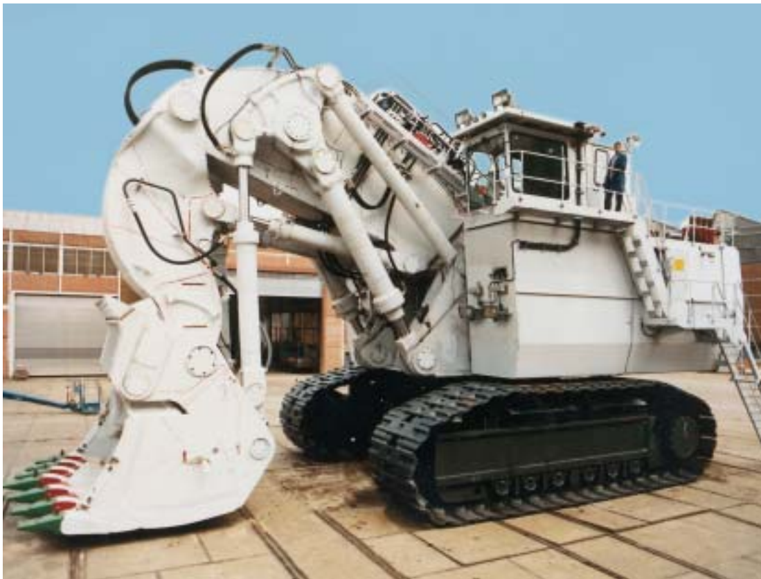
Figure 4 : Excavatrice hydraulique RH 400 de la société O&K : éléments portants en DILLIMAX 690 T (photo publiée avec l'aimable autorisation d'Orenstein & Koppel AG, Dortmund, Allemagne)
