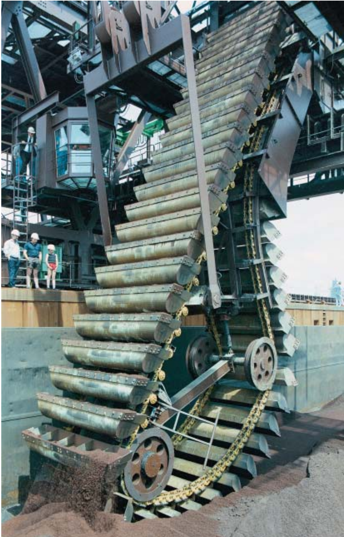
Figure 10 : Appareil de déchargement en continu de navires dans le port de DILLINGER HÜTTE GTS
