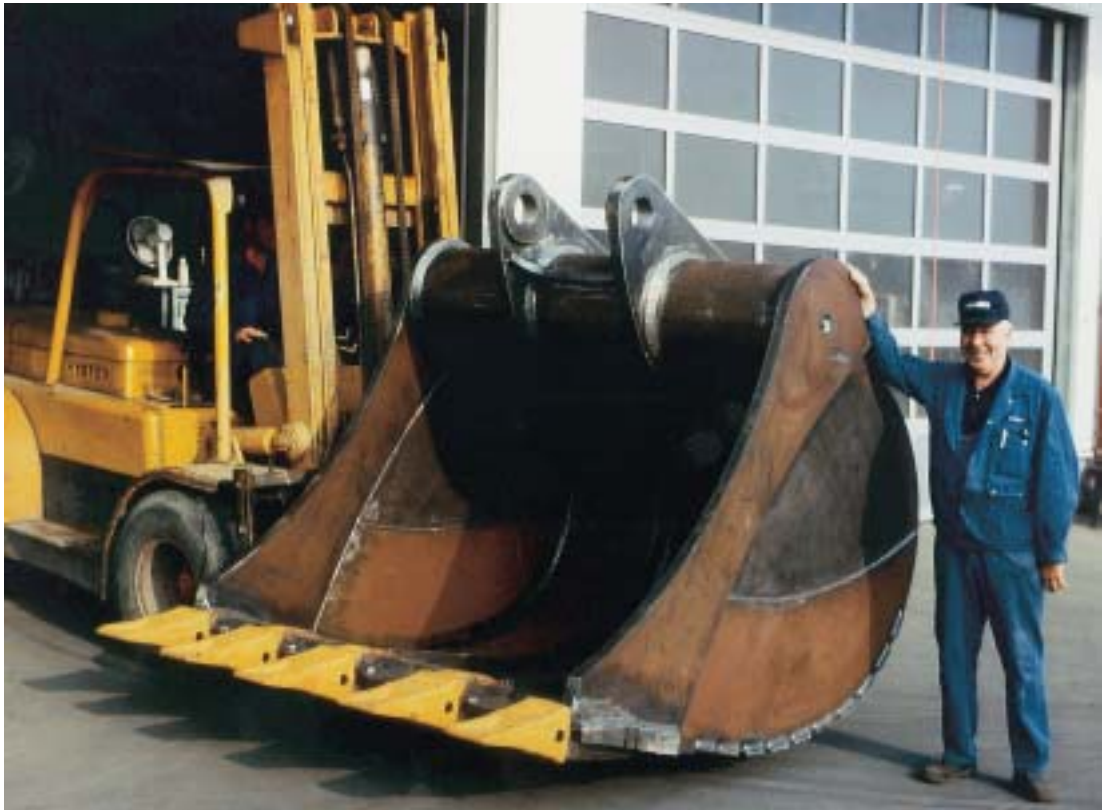
Figure 20 : Godet de pelle soudé en DILLIDUR V (photo publiée avec l'aimable autorisation de Schlüter Baumaschinen, Erwitte, Allemagne)
