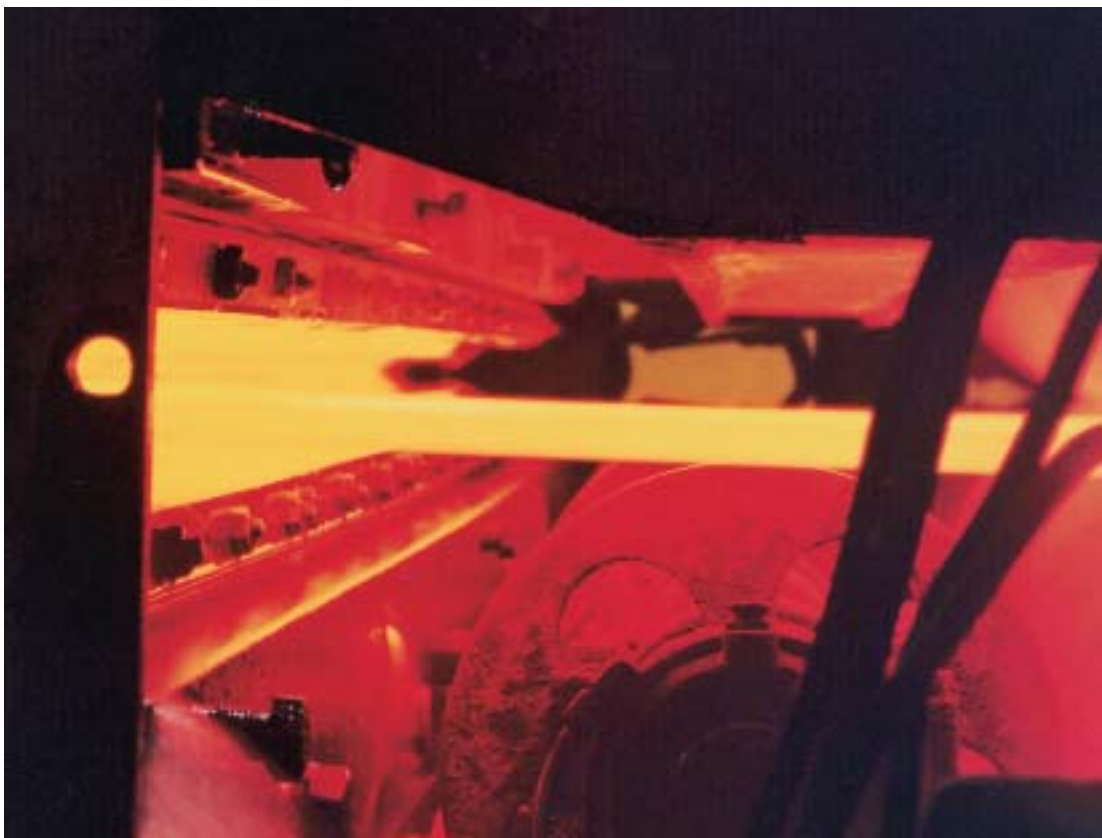
Figure 5 : Une tôle austénisée en DILLIDUR V entre dans l'installation de trempe
