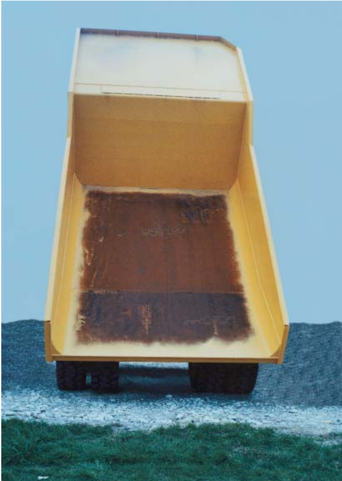
Figure 21 : Benne basculante de camion en DILLIDUR 400 V, épaisseur de la tôle : 10 mm
