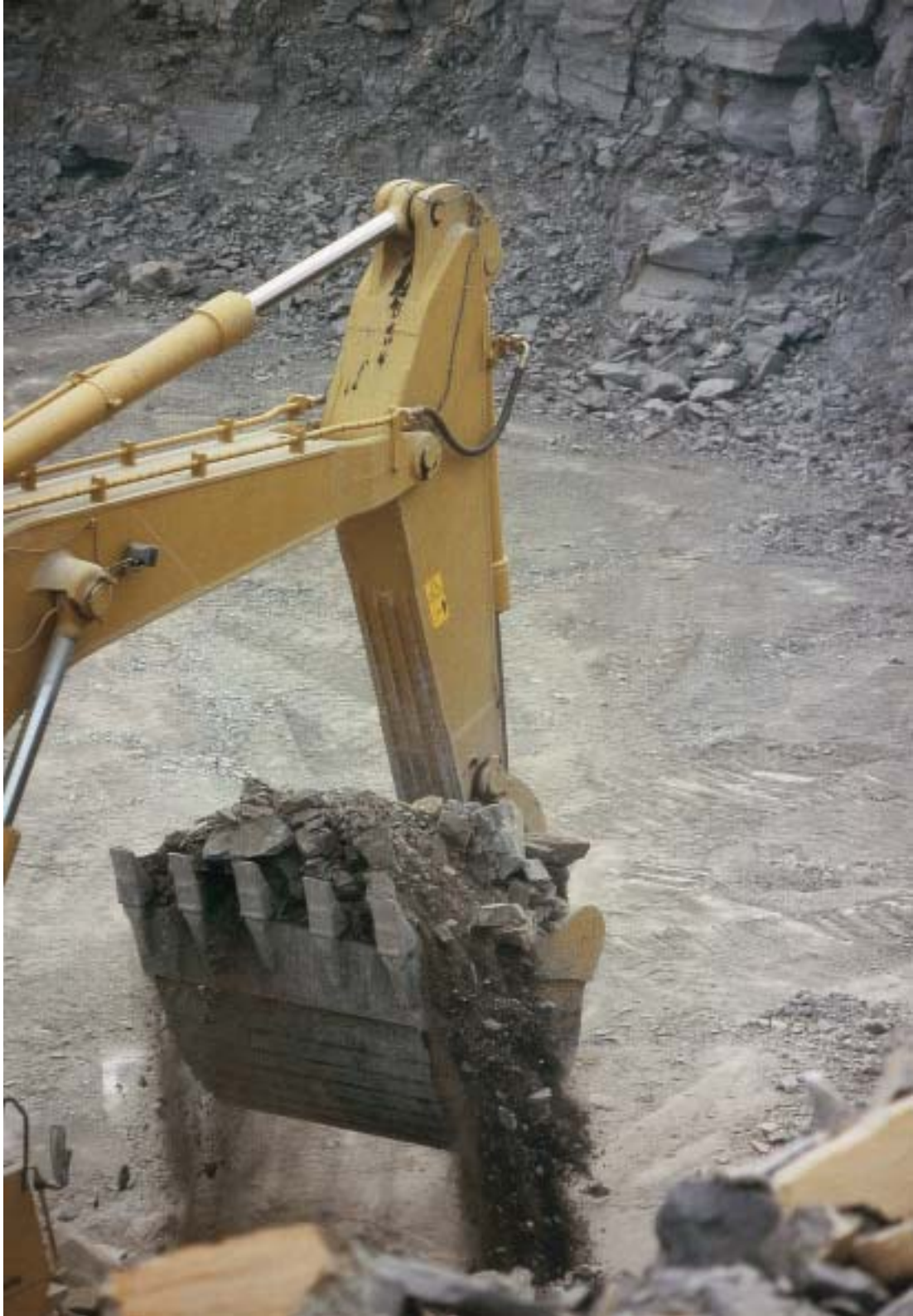
Figure 1 : Pelle mécanique en acier DILLIDUR V opérant dans les conditions difficiles d'une exploitation à ciel ouvert (photo publiée avec l'aimable autorisation de Schlüter Baumaschinen, Erwitte, Allemagne)
