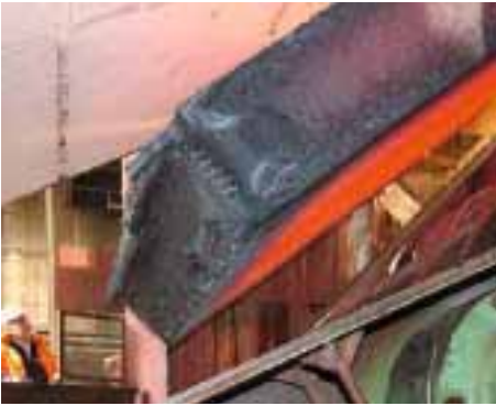
Mit Dicken bis 450 mm produziert die Dillinger Hütte erneut die dicksten Brammen der Welt.
