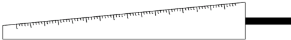
Bild 1: Messkeil zur Abstandsmessung
