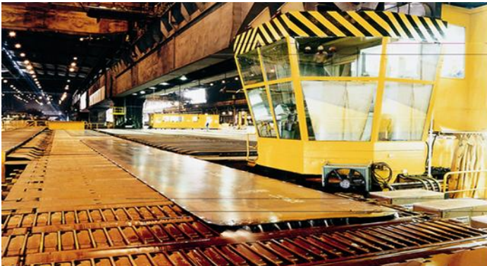
US-Grobblechprüfanlage für Blechdicken bis zu 55 mm in der Scherenlinie
