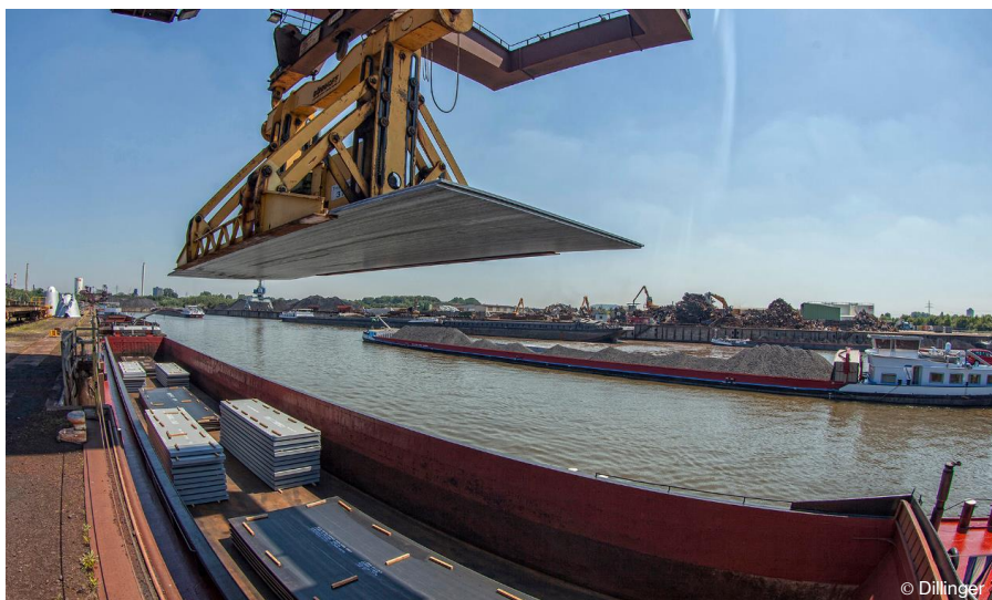
Bild 2 Bisherige Be-/Entladung im Hafen von Dillingen mit Zange und Kanthölzern
